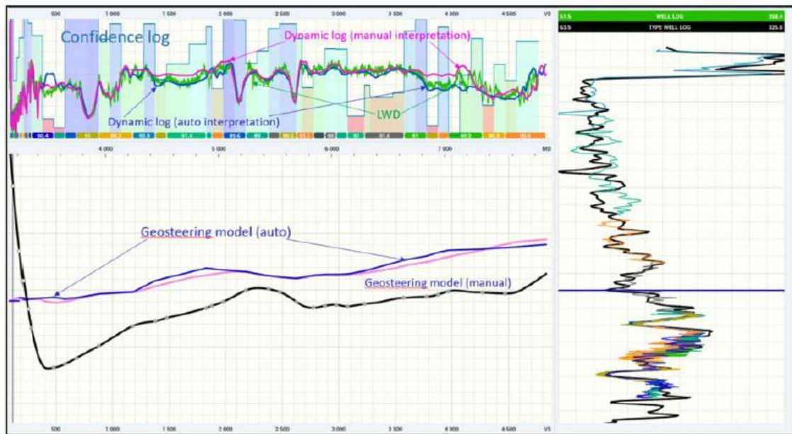
Рисунок 1. Сравнение результатов ручной и автоматической настройки [19].
