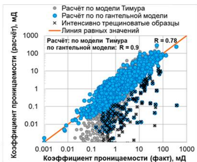
Рис. 2. Сопоставление результатов расчета с данными измерений коэффициента проницаемости на образцах керна
