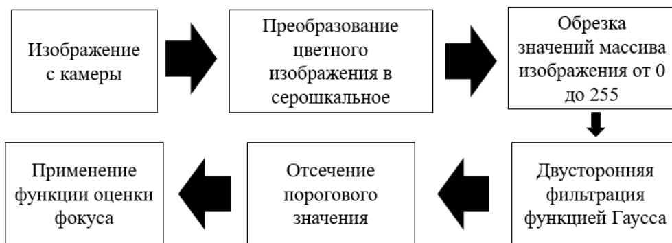
Рис. 1. Схема обработки изображения в процессе работы алгоритма автофокусировки
