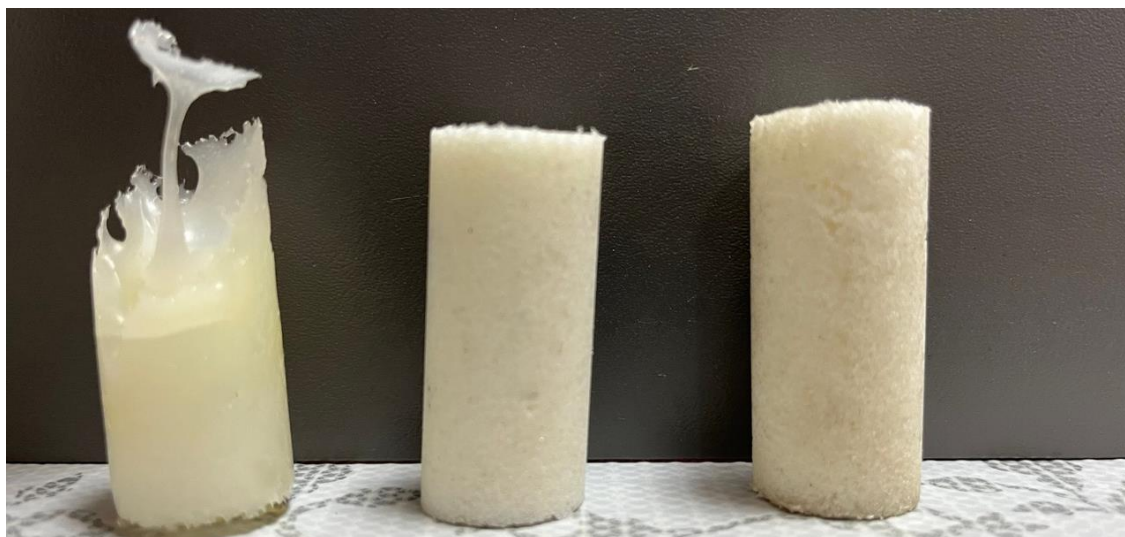
Рис. 1. Образцы, полученные путем спекания различной поглощенной дозы
