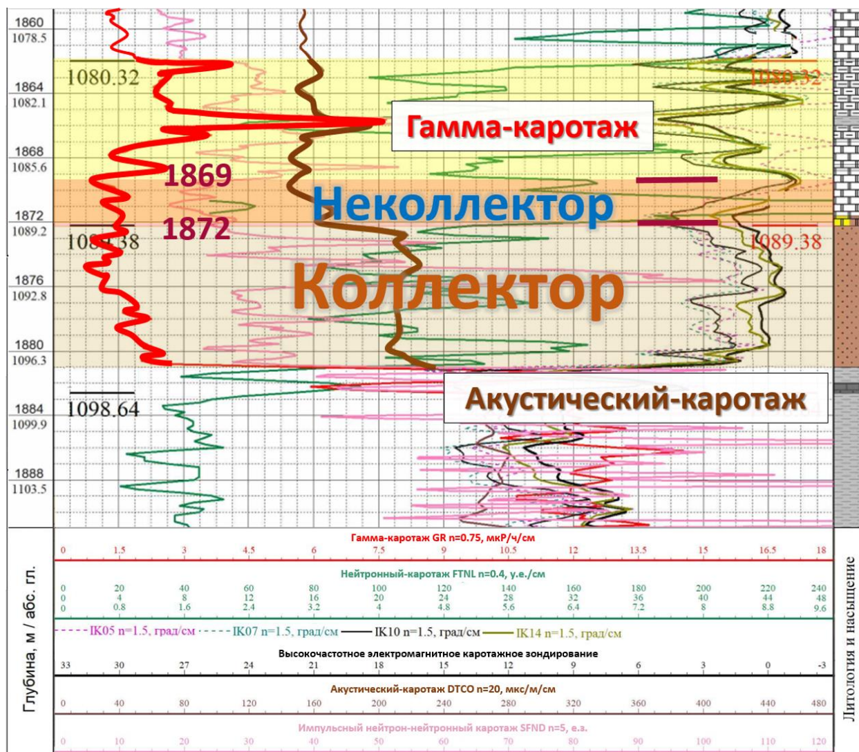
Рис. 1. Типовой геолого-геофизический разрез по одной из скважин рассматриваемого месторождения
