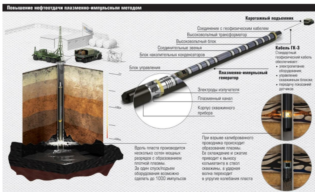
Рис. 1. Методология ПИВ и устройство плазменно-импульсного генератора
