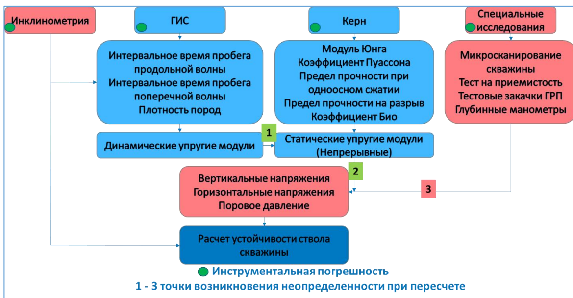
Рис. 1. Схема входных данных для построения одномерной геомеханической модели
