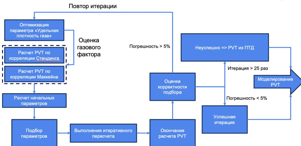
Рис. 1. Схема модуля подбора PVT-свойств
