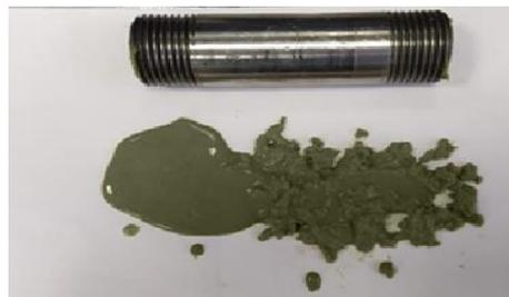
Рис. 4. Фотография извлеченного из кернодержателя материала НМП с отвержденным изоляционным составом на основе АПГ
