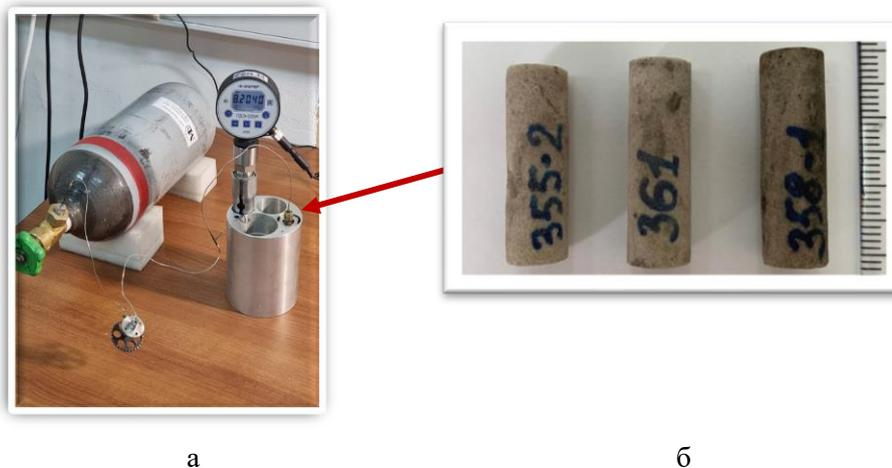
**Рис. 1.** Установка (а) для нагнетания водород-метановой смеси по системе капилляров в ячейку с образцом керна (б), рабочее давление 8 МПа
