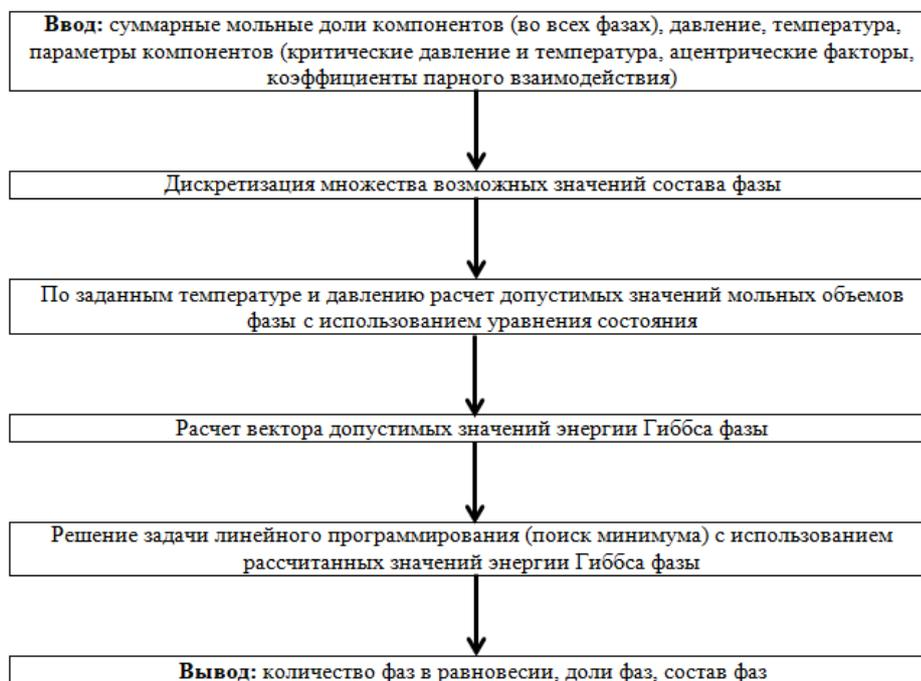
Рис. 1. Блок-схема метода прямой минимизации энергии Гиббса системы
