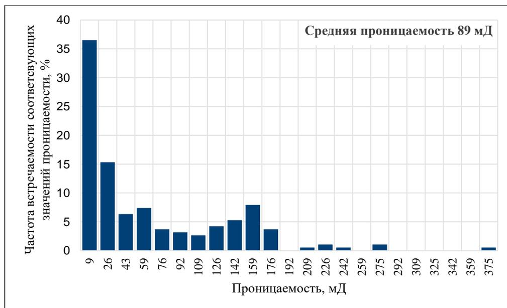
Рис. 2. Гистограмма распределения проницаемости в интервалах со стилолитовыми и литогенетическими трещинами
