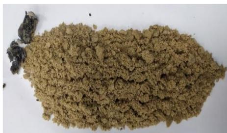
Рис. 1. Фотография извлеченного из кернодержателя материала НМП с отвержденным изоляционным коммерческим составом
