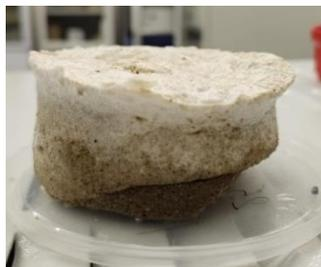
Рис. 3. Полимеризация в насыпной модели пласта
