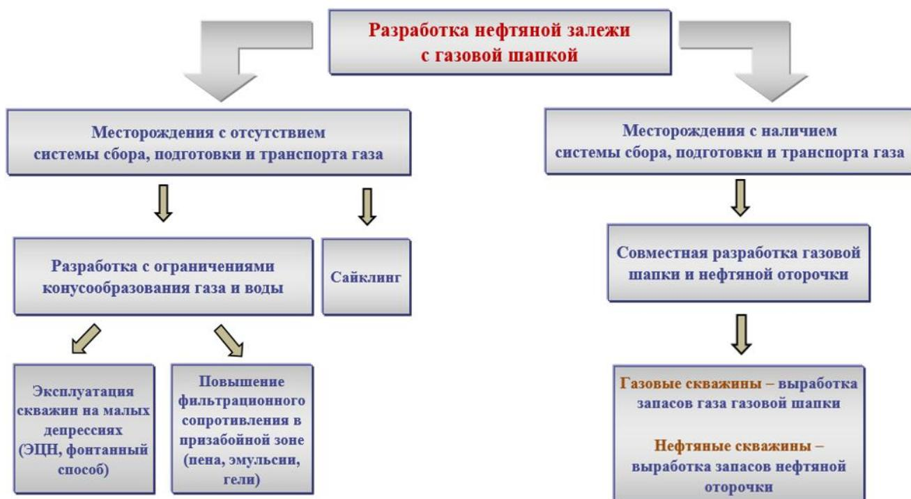
Рисунок 1.1 – Схема современных способов разработки нефтяной залежи с газовой шапкой и подстилаемой водой
