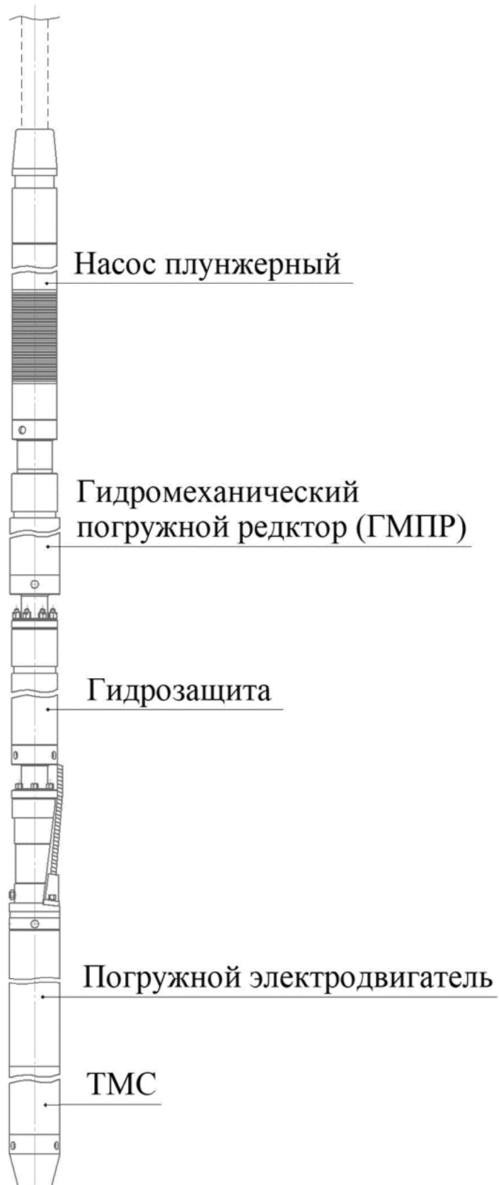
Рисунок 2.2 – Схема нефтяной насосной установки на базе ГМПР
