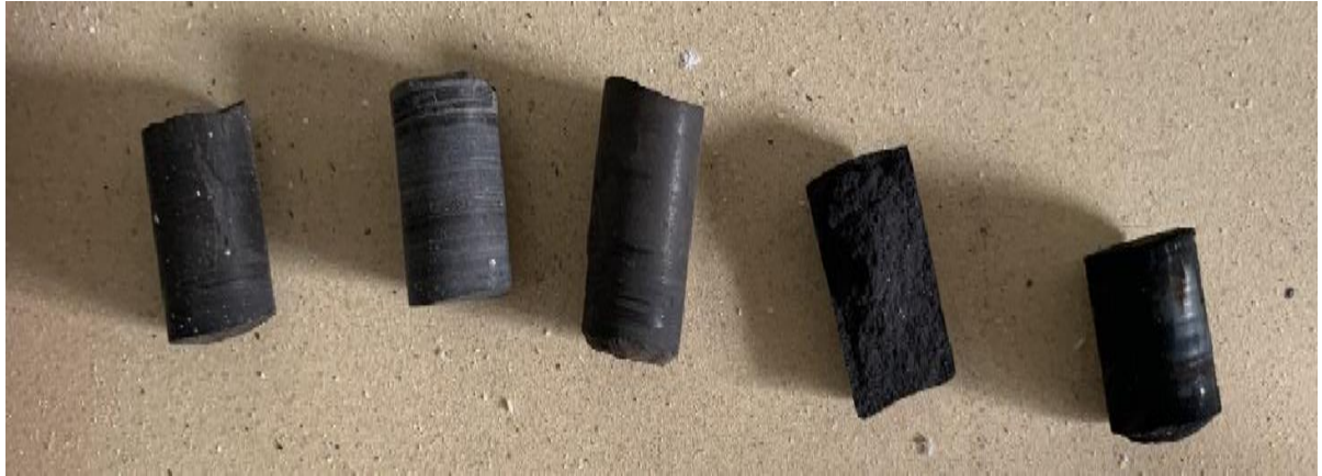
Рисунок 6 – Экспериментальные образцы после пиролиза слева направо 100-200-300-400-500°C, соответственно
