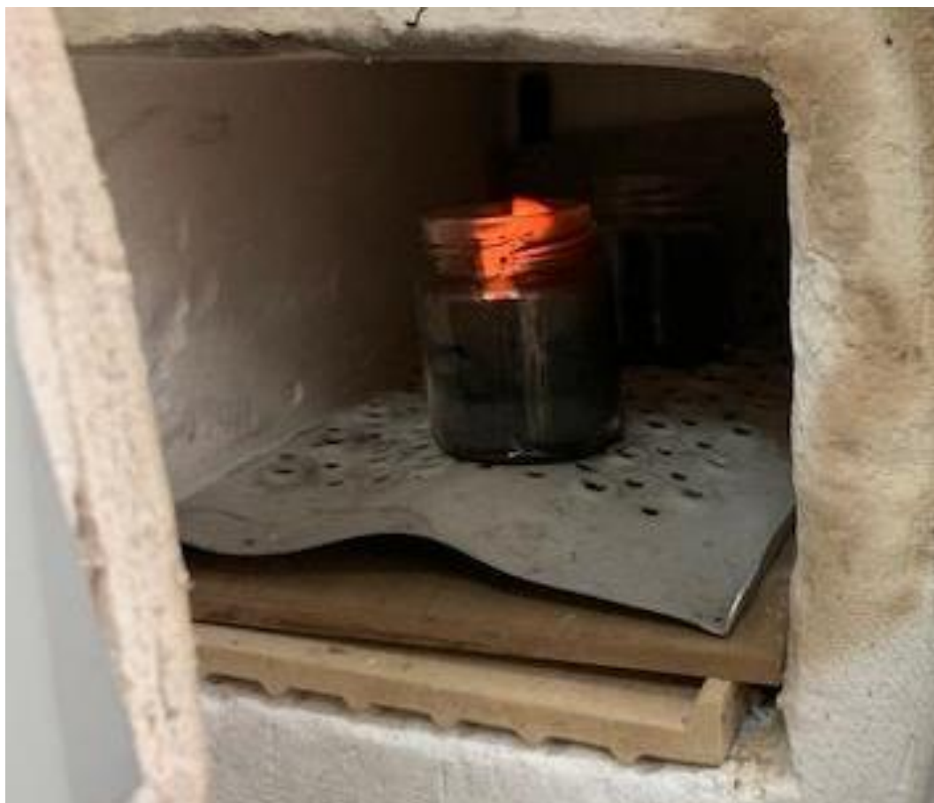
Рисунок 52 – Процесс сгорания фильтровальной бумаги и углеводов в муфельной печи
