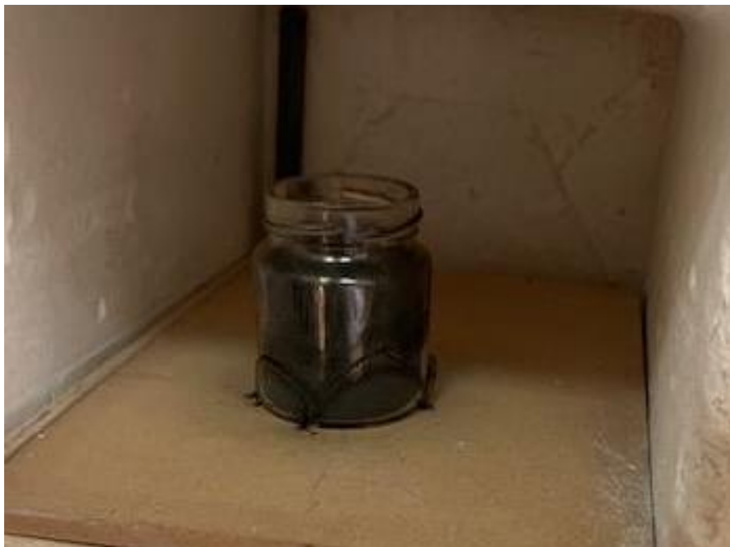
Рисунок 53 – Фрагмент разработки методики по определению C_{орг} : лопнувшее стекло при прокаливании образцов
