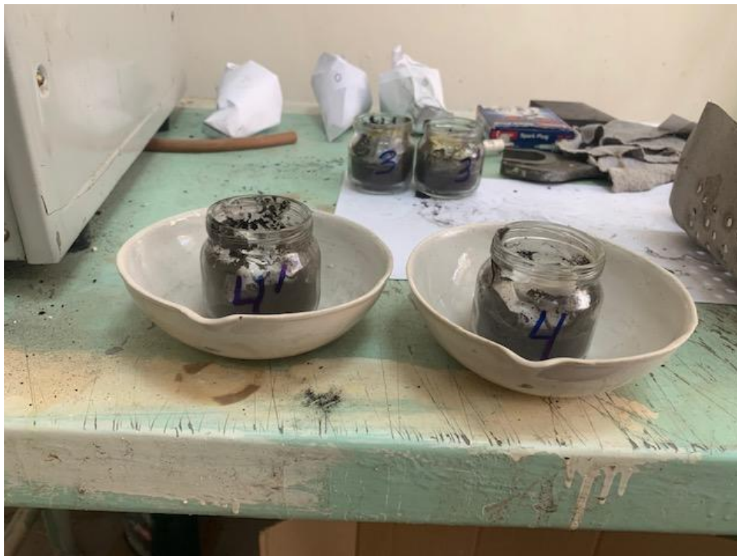
Рисунок 54 – Экспериментальные образцы в керамической круглодонной посуде перед прокаливанием в муфельной печи
