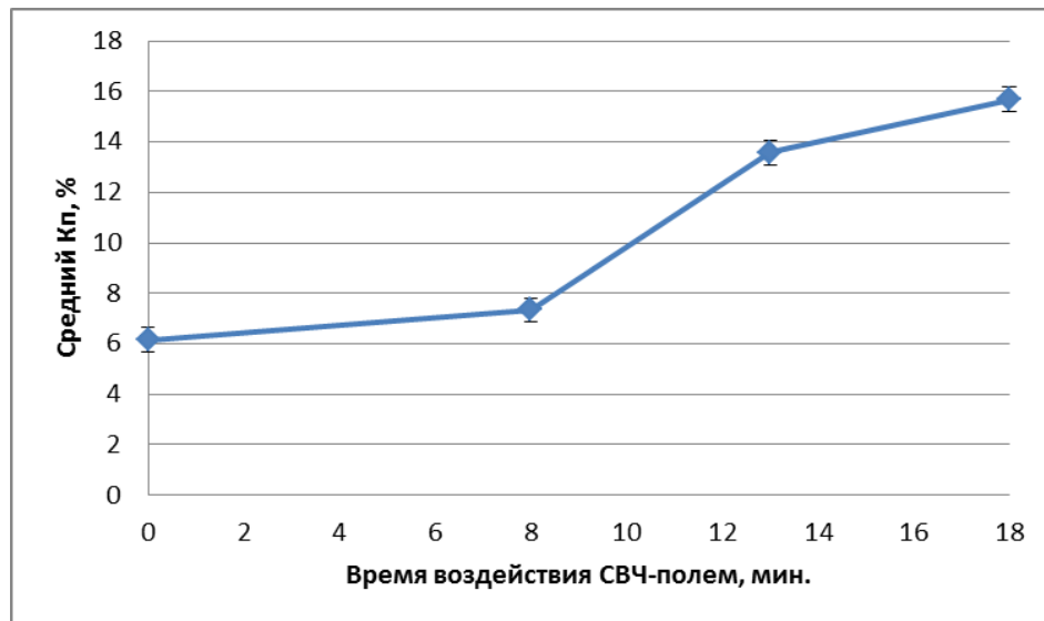
Рисунок 21 – Зависимость изменения коэффициента пористости от времени воздействия СВЧ-полем.
