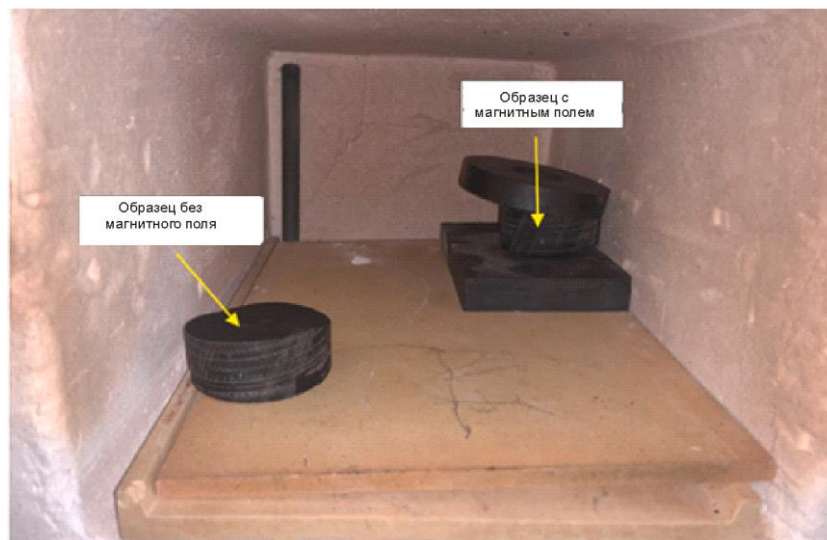
Рисунок 48 – Пример расположения экспериментальных образцов в муфельной печи
