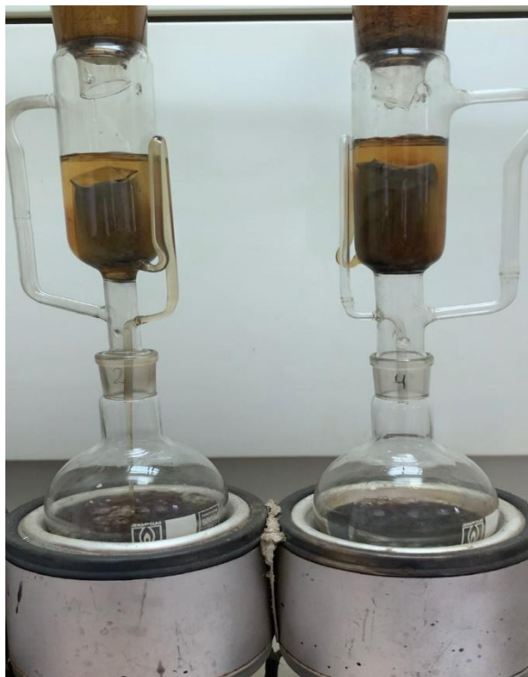
Рисунок 49 – Экстракция хлороформенного битумоида на аппарате Сокслета
